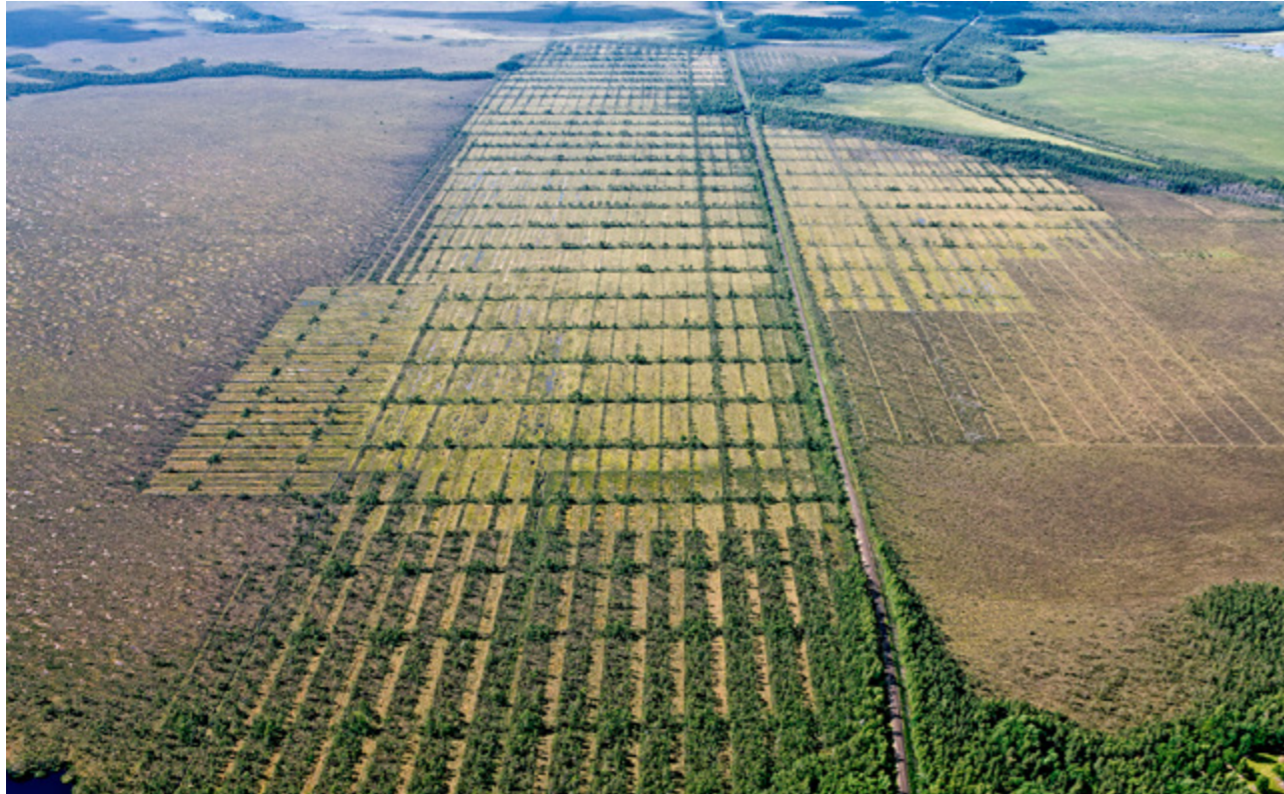
I Store Mosse nationalpark finns en gammal täkt där man har brutit strötorv från början av 1900-talet fram till 1966. Brytningen har utförts i sidled genom att man har öppnat smala torvgravar som sedan successivt breddats allt eftersom brytningen fortskridit. Resultatet blir ett rutnät av rektangulära torvgravar med torra uppstickande plintar emellan. I nedre delen av bilden är torvgravarna smalare vilket beror på att brytningen inte helt slutfördes där innan verksamheten lades ned. Till höger i bilden ser man ett område som dikats inför torvbrytning, men där brytning sedan inte påbörjades. Foto: Bergslagsbild AB.
