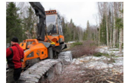
Mindre bandgående skördare som kan byggas om till skotare. Foto: Kristin Lindström.
