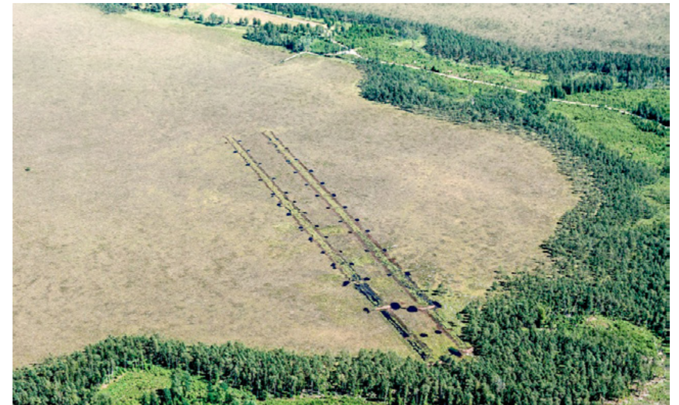
Igenlagda diken på Taglamyren i Kronobergs län. Intill dikena syns de vattenfyllda gropar där torvmassor tagits till igenfyllning och bygge av dämmen. Foto: Bergslagsbild AB.
