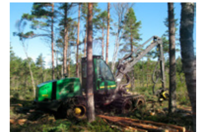
Skördaren kräver ganska fast mark för att ta sig fram, trots att den, som i detta fall, är utrustad med band på de främre hjulparen. Foto: Mikael Burgman.
