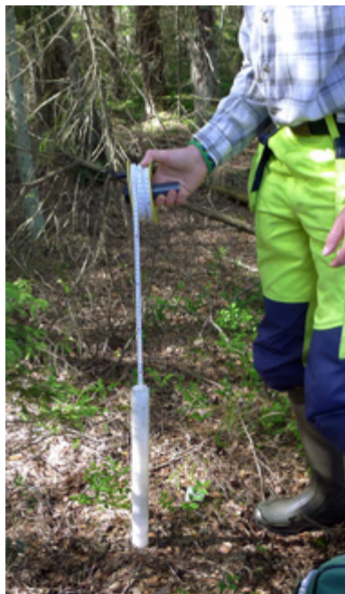
Mätning av vattennivå i grundvattenrör. Foto: Vilmer Paulsson.
